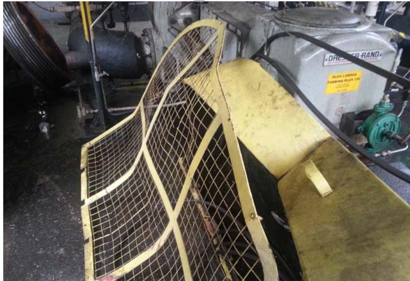
O compressor foi colocado em operação sem carga para rodar e quando colocou a carga o compressor explodiu. O trabalhador da empresa terceirizada, Jose Kleber Martins, foi atingido por pedaços do compressor. Apesar da gravidade o trabalhador teve sorte de não morrer.
